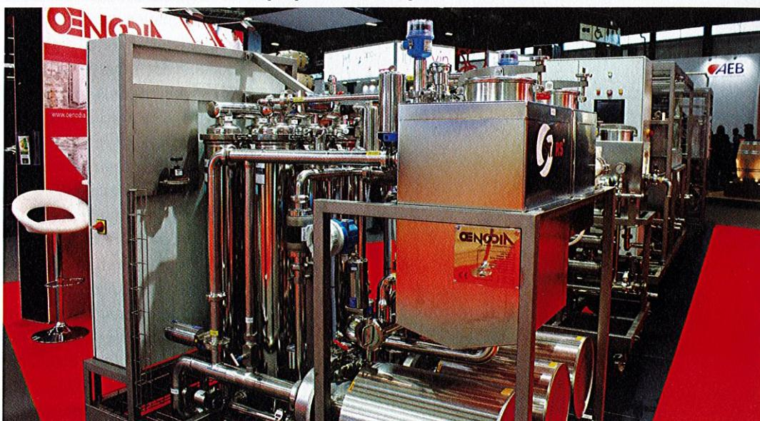
filtré et stabilisé). Tout transfert de vin entre la filtration et la stabilisation tartrique est éliminé. Les risques de dissolution de l'oxygène de l'air sont minimisés (< 0,2 mg/l entre l'entrée du vin brut et la sortie du vin filtré et stabilisé) et sans perte notable de CO<sub>2</sub>. Le nombre de sulfitages est réduit, en raison de la réduction du nombre de transfert de vin.
