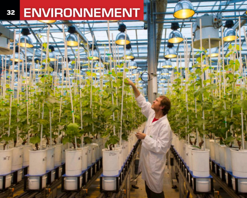
**A l'Inra de Montpellier, la plateforme robotisée PhénoArch analyse automatiquement la croissance de 1 620 pieds de vigne issus de croisements génétiques, ainsi que leur résistance à la température et la sécheresse.**
